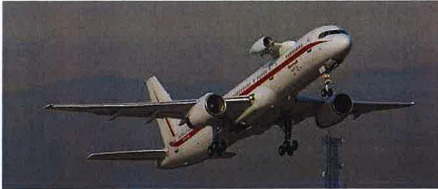
Figure 1: Avion Banc d'Essais moteur Honeywell Boeing 757
