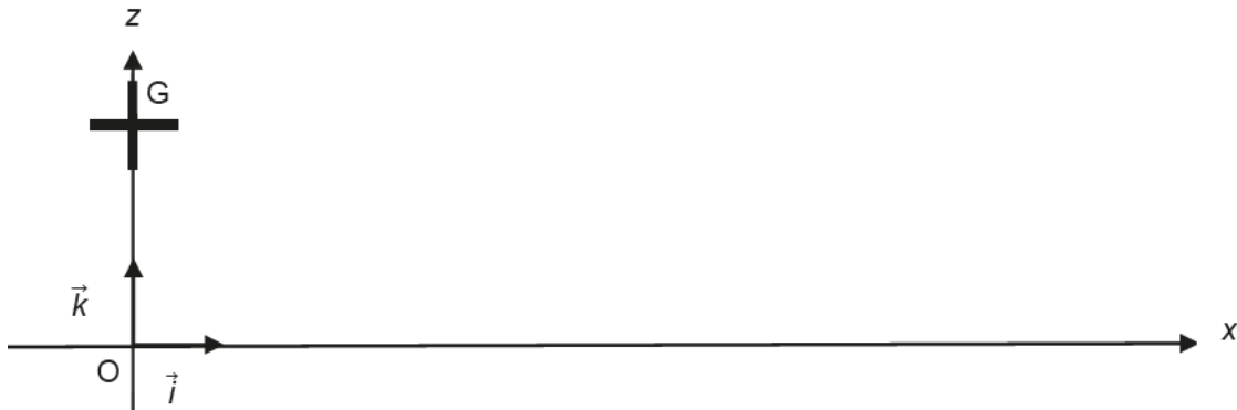
Figure 2. Système d'axes et vecteurs unitaires associés au référentiel terrestre
