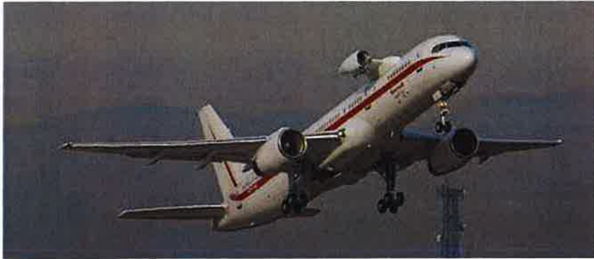
Figure 1: Avion Banc d'Essais moteur Honeywell Boeing 757
