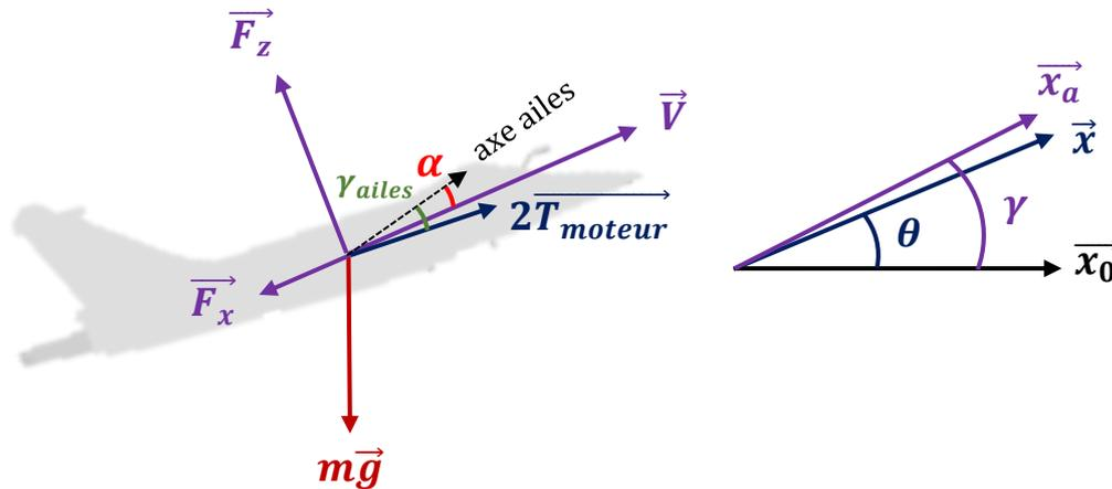
La composante verticale de portance et la composante verticale de poussée moteurs compensent le poids et la composante verticale de traînée.
