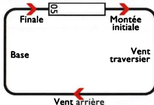
On considère que seule la branche « vent arrière » du tour de piste permet de recharger le(s) batterie(s) 48 V de l'avion, et qu'elle dure en moyenne 3 min à 75 kts. Il n'y a pas ou peu de récupération d'énergie quand les moteurs thermiques sont à bas régime, car les hélices sont trop petites pour fonctionner en génératrices en descente avec un rendement significatif.
