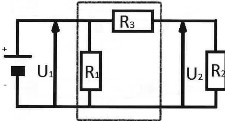
Soit un dispositif résistif quelconque à l'entrée duquel on applique une tension  $U_1$  correspondant à un courant d'intensité  $I_1$ , et aux bornes duquel on mesure la tension  $U_2$  et le courant de sortie  $I_2$  (ce qui implique au minimum, et suivant le type de courant, une résistance -ou impédance- équivalente  $R_2$  branchée aux bornes du dispositif).
