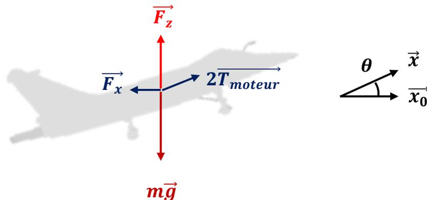
Au moment où l'avion décolle, la réaction du sol est complètement remplacée par la portance et la composante verticale de poussée des moteurs.
