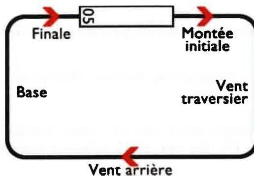
On considère que seule la branche «vent arrière» du tour de piste permet de recharger le(s) batterie(s) 48 V de l'avion, et qu'elle dure en moyenne 3 min à 75 kts. Il n'y a pas ou peu de récupération d'énergie quand les moteurs thermiques sont à bas régime, car les hélices sont trop petites pour fonctionner en génératrices en descente avec un rendement significatif.
