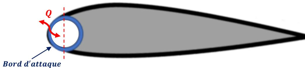
*Profil de l'aile, avec la conduite au niveau du bord d'attaque.*
