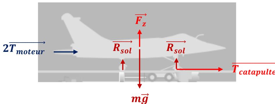
Au fur et à mesure que l'avion gagne de la vitesse, la portance se substitue à la réaction du sol.
