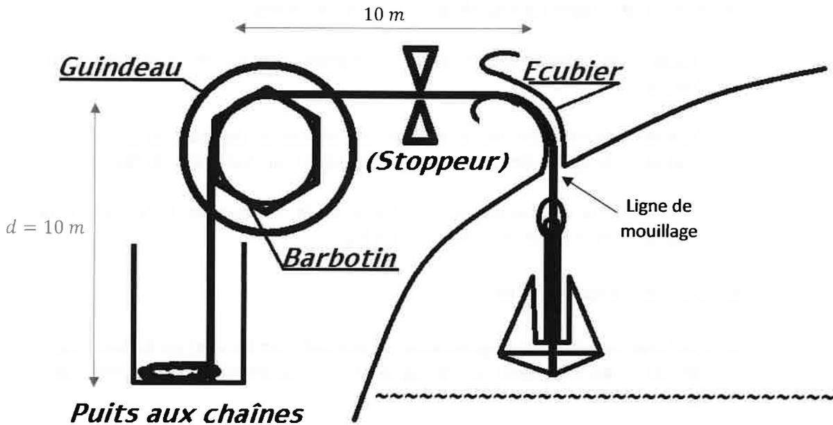
En croisière, la ligne repose essentiellement dans le puits aux chaînes. En vue du mouillage, elle en est extraite par un moteur accouplé au guindeau, lequel peut également servir de frein pendant le déroulement. Les mailles de la ligne sont entraînées par le barbotin (donc sans glissement), solidaire du guindeau. Le stoppeur n'intervient pas dans la phase « active » du mouillage de l'ancre (déroulement continu).
