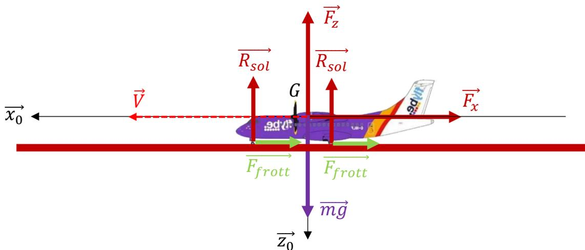
La portance est remplacée petit à petit par la réaction du sol. L'incidence des ailes est égale au calage  $\varepsilon$ .
