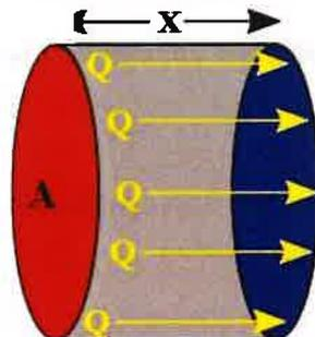
1) Dans un barreau homogène de section A (en m<sup>2</sup>) et isolé mis simplement en contact avec une source chaude et une source (plus) froide (de températures respectives T<sub>c</sub> et T<sub>f</sub>), le taux de transfert par conduction de chaleur dQ (en J) par unité de temps dt vaut :
