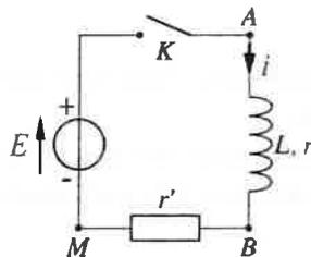
1) Etablir l'équation différentielle qui définit la tension  $E$  en fonction du courant  $i$  et des éléments du circuit.
