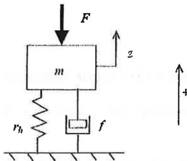
Une masse mobile  $m$  de 800 kg est fixée sur un vérin hydraulique assimilable à un ressort de raideur hydraulique  $r_h = 7,5 \cdot 10^6$  N/m et à un frottement visqueux de coefficient  $f$ . L'ensemble est soumis à un effort de perturbation  $F(t)$  variable dans le temps, dirigé selon l'axe Z et représentatif des efforts liés aux mouvements de l'atmosphère et des ordres de pilotage.
