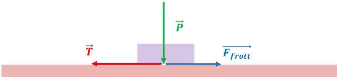
Avec le coefficient d'adhérence  $f$ . On a l'évolution de  $F_{frott}$  en fonction du module de la force tractrice  $\vec{T}$  :
